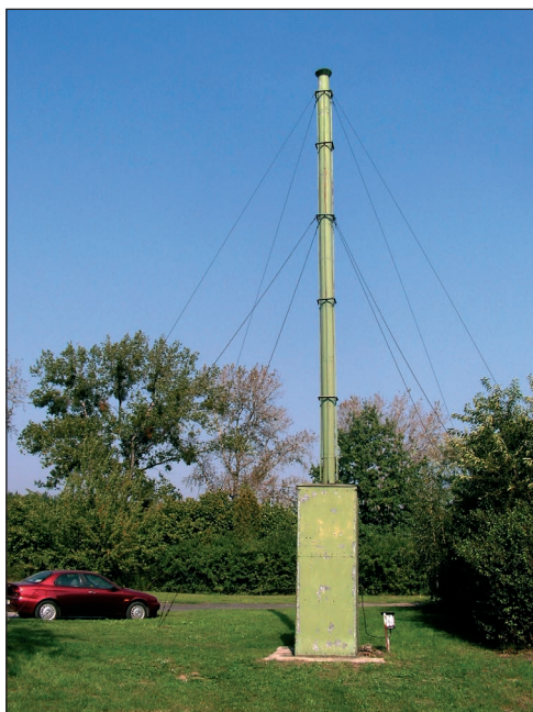
Fot. 1. Aspirator ssący Johnsona w IOR w Poznaniu odławia nieprzerwanie mszycę od roku 1973 – pozwala na precyzyjną sygnalizację terminu lotów wektorów wirusów
