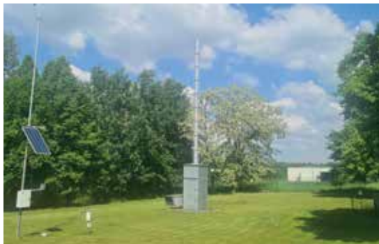
Aspirator Johnsona do odłowów aeroplanktonu na terenie IOR – PIB Oddział Sońnicowice.
