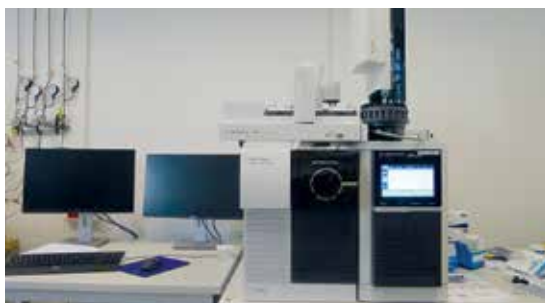
Chromatograf gazowy sprzężony z kwadropolową tandemową spektrometrią mas (GC-MS/MS).
