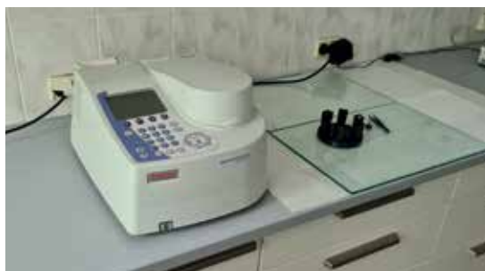
Stanowisko analizy ditiokarbaminianów – spektrofotometr UV/VIS.
