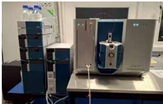
Chromatograf cieczowy sprzężony z kwadropolową tandemową spektrometrią mas (LC-MS/MS).
