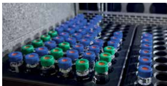
Automatyczny podajnik próbek – system ultrawysokosprawnej chromatografii cieczowej (UHPLC).
