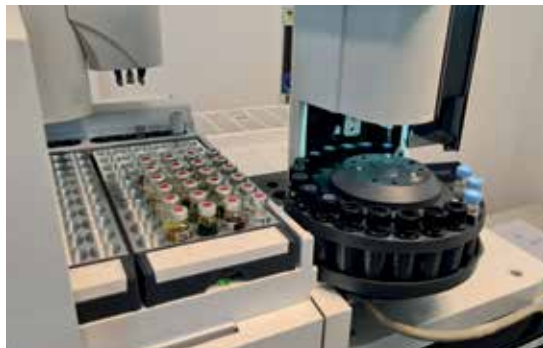
Automatyczny podajnik próbek chromatografu gazowego sprzężonego ze spektrometrem mas.
