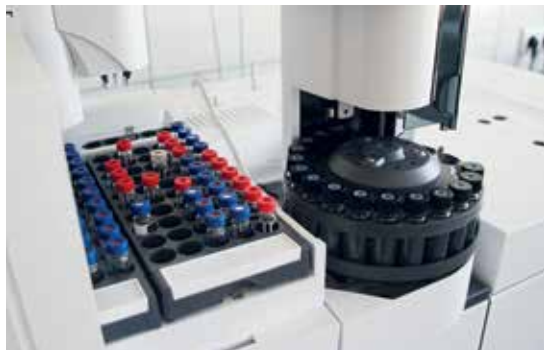
Automatyczny podajnik próbek do chromatografu gazowego.
