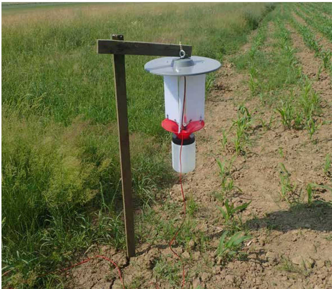
Fot. 2.31. Manualna, akumulatorowa pułapka świetlna (fot. P. Beres)
