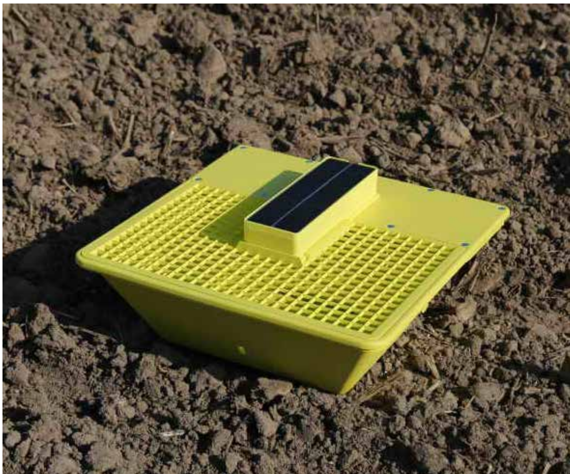
Fot. 2.10. Żółta pułapka na szkodniki rzepaku z kamerą oraz systemem identyfikacji i liczenia owadów (fot. Bayer.com.pl)
