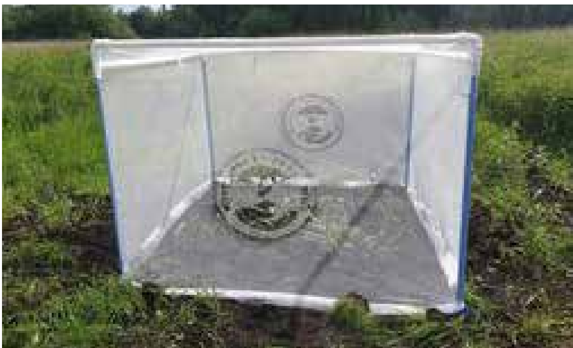
Fot. 2.36. Przykład izolatora polowego (fot. Ł. Kontowski)
