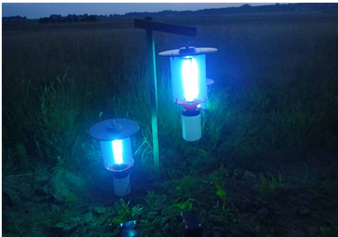
Fot. 2.30. Pułapka świetlna musi emitować światło atrakcyjne dla danego szkodnika, zwykle jest to UV (fot. P. Bereś)
