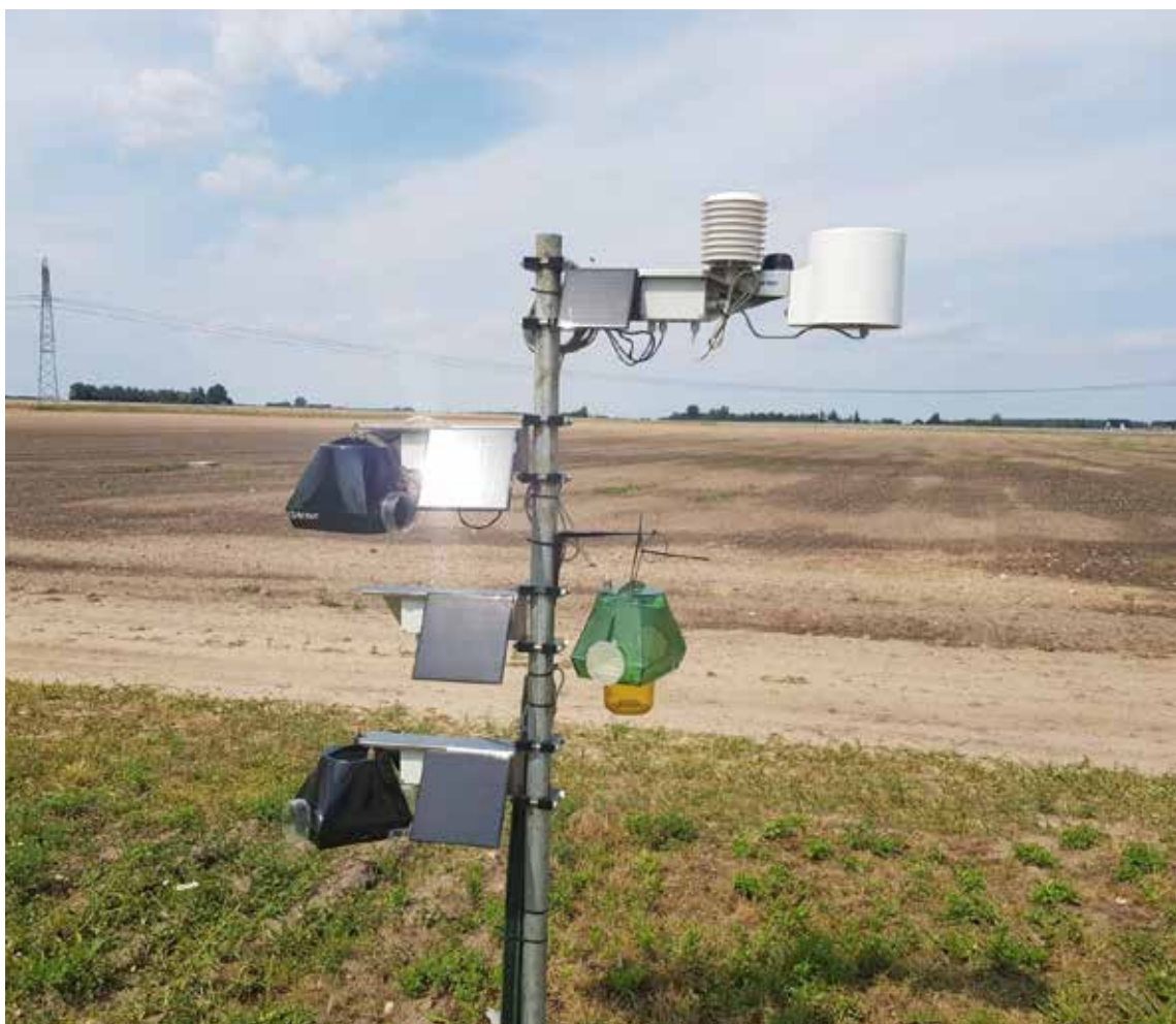
Fot. 2.29. Automatyczne pułapki feromonowe sprzężone ze stacją pogodową (fot. M. Wilanowski)
