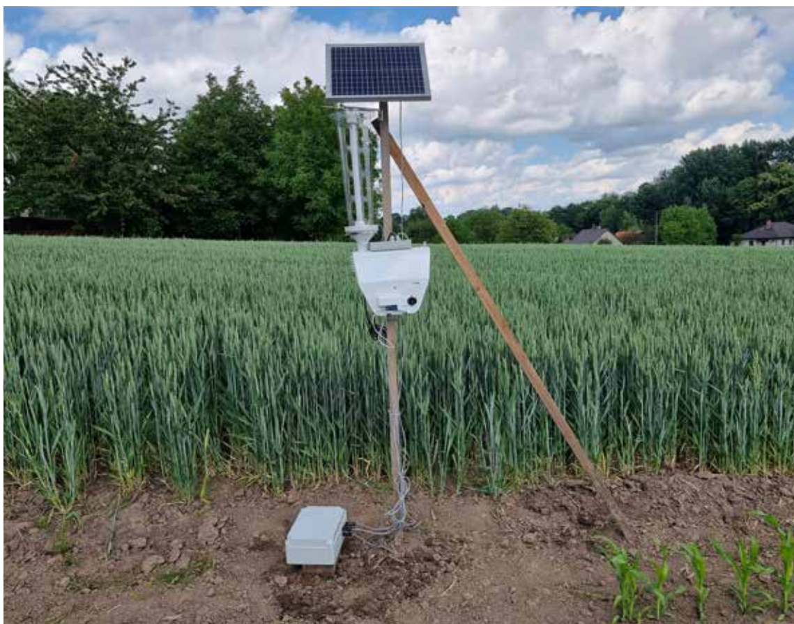
Fot. 2.33. Automatyczna pułapka świetlna sprzężona ze stacją pogodową (fot. P. Bereś)
