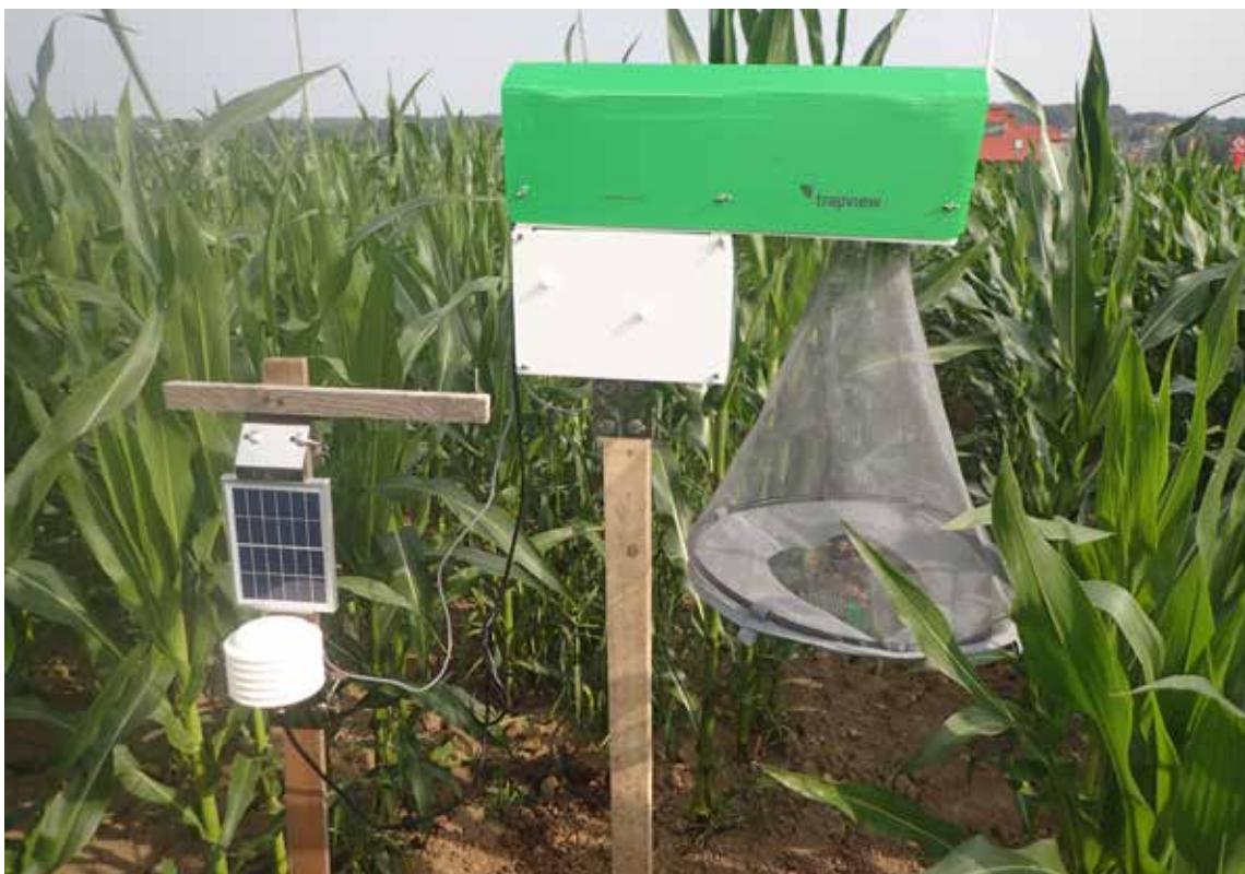
Fot. 2.28. Automatyczna pułapka feromonowa ze stacją meteorologiczną (fot. P. Beres)
