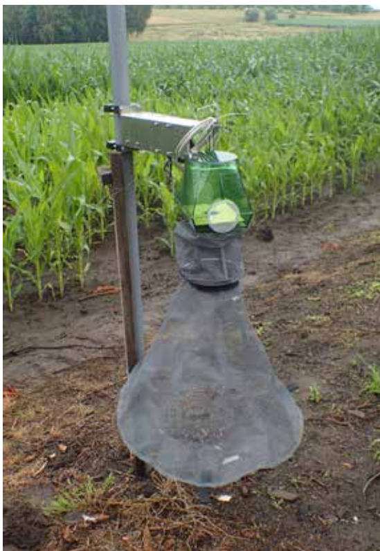
Fot. 2.26. Automatyczna pułapka feromonowa (jeden z modeli) do odłowu na przykład różnych gatunków motyli (fot. P. Beres)
