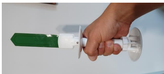
Fot. 9. Czujnik doglebowy mierzący dynamikę zmian wilgotności i temperatury gleby
