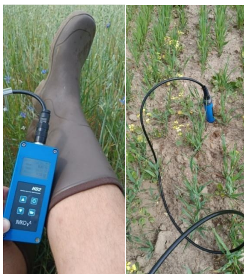
Fot. 7 - 8. Pomiary wykonywane za pomocą sondy doglebowej SONO TRIME-PICO 32i rejestratora danych IMKO HD2.
