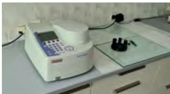
Stanowisko analizy ditiokarbaminianów – spektrofotometr UV/VIS.
