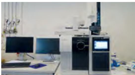
Chromatograf gazowy sprzężony z kwadrupolową tandemową spektrometrią mas (GC-MS/MS).
