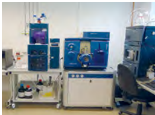
Chromatograf cieczowy sprzężony z kwadrupolową tandemową spektrometrią mas.
