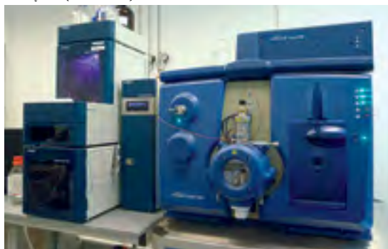
Chromatograf ciekłowy sprzężony z kwadrupolową tandemową spektrometrią mas (LC-MS/MS).
