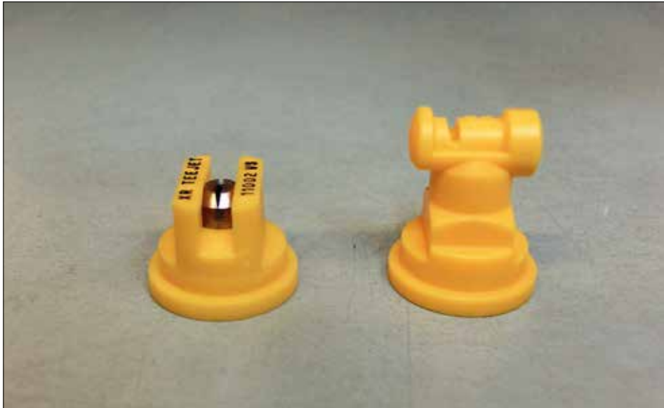
Fot. 23. Rozpylacz jednostrumieniowy rozmiar 02 (żółty): klasyczny (po lewej) i uderzeniowy (po prawej) różnią się charakterystyką wytworzonych kropli, gdy pracują pod tym samym ciśnieniem cieczy. Dla 0,3 MPa, pierwszy klasyfikowany jest jako drobnokroplisty, drugi średniokroplisty (fot. H. Ratajkiewicz)
