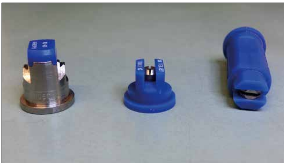
Fot. 22. Wielkość kropli wytwarzana przez rozpylacz o płaskim strumieniu zależy od jego konstrukcji. Przy tym samym wydatku i pod ciśnieniem 0,3 MPa rozpylacze przedstawione na zdjęciu klasyfikowane są następująco: bardzo drobnokroplisty – klasyczny rozpylacz dwustrumieniowy (po lewej), drobnokroplisty – klasyczny rozpylacz jednostrumieniowy (w środku), bardzo grubokroplisty – rozpylacz eżektorowy (po prawej) (fot. H. Ratajkiewicz)
