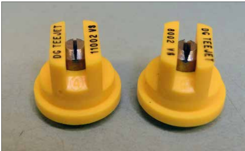
Fot. 25. Rozpylacze różniące się kątem strumienia kropli, 110° po lewej i 80° po prawej różnią się ukształtowaniem (szerokością) szczeliny wylotowej, co skutkuje wytwarzaniem nieco większych kropli przez rozpylacz o węższym strumieniu (fot. H. Ratajkiewicz)
