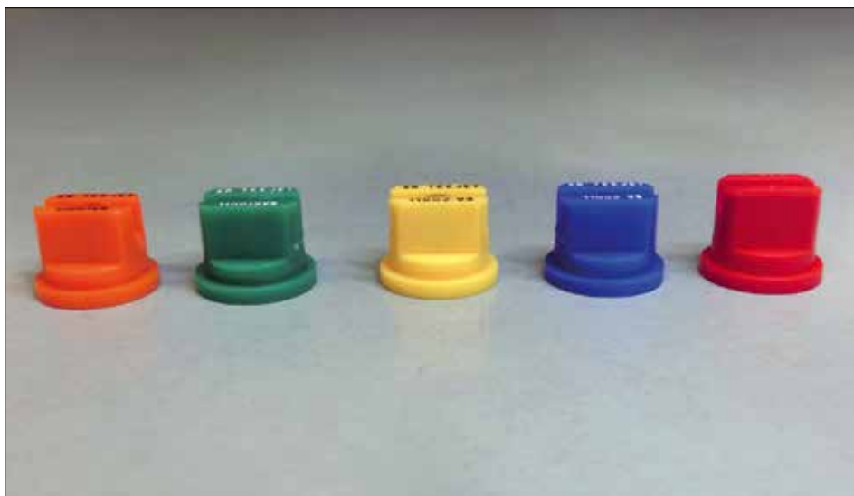
Fot. 21. Zgodnie z normami ISO kolor rozpylacza koduje jego wydajność cieczy w ciągu 1 minuty. Rozpylacze o większym wypływie cieczy wytwarzają krople o większych rozmiarach, gdy pracują pod tym samym ciśnieniu. Od lewej rozmiar: 01, 015, 02, 03 i 04 (fot. H. Ratajkiewicz)
