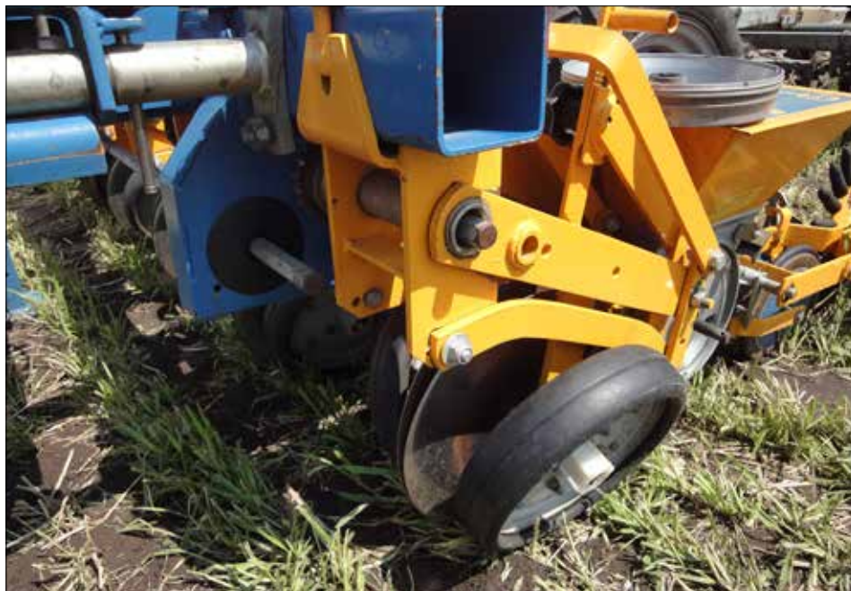
Fot. 6. Siewnik punktowy wyposażony w kroje tarczowe umożliwiające siew buraków w mulcz (fot. M. Nowakowski)
