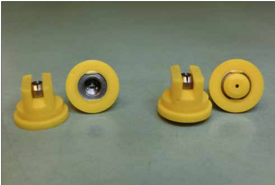
Fot. 52. Rozpylacz wyposażony w kryż wstępną (po prawej) wytwarza krople większe i mniej podatne na znoszenie niż rozpylacz klasyczny (po lewej), mimo że ukształtowanie szczeliny wylotowej jest takie same (fot. H. Ratajkiewicz)
