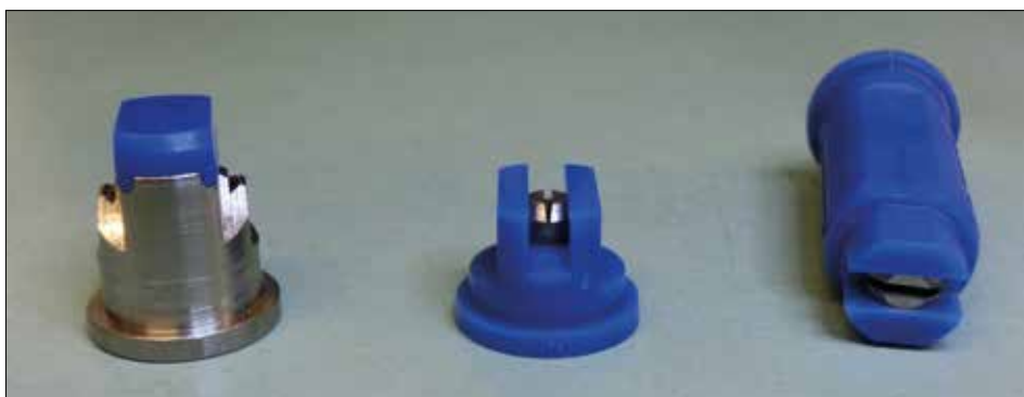
Fot. 50. Wielkość kropli wytwarzana przez rozpylacz o płaskim strumieniu zależy od jego konstrukcji. Przy tym samym wydatku i pod ciśnieniem 0,3 MPa rozpylacze przedstawione na zdjęciu klasyfikowane są następująco: bardzo drobnokroplisty – klasyczny rozpylacz dwustrumieniowy (po lewej), drobnokroplisty – klasyczny rozpylacz jednostrumieniowy (w środku), bardzo grubokroplisty – rozpylacz eżektorowy (po prawej) (fot. H. Ratajkiewicz)
