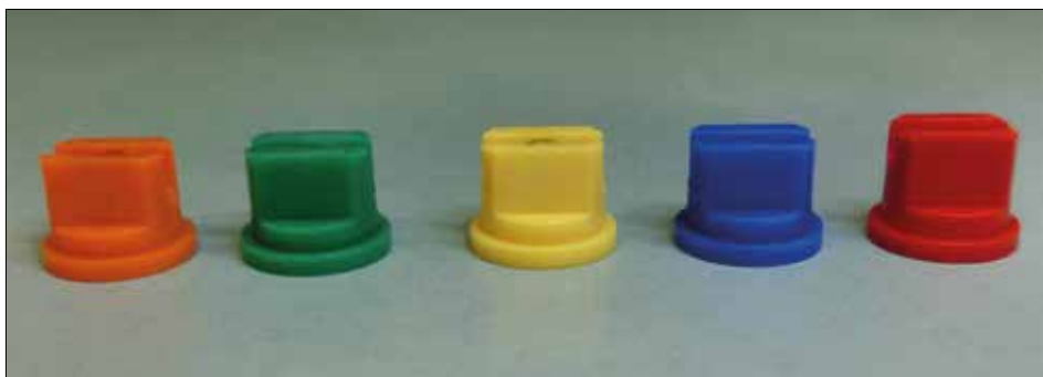
Fot. 49. Zgodnie z normami ISO kolor rozpylacza koduje jego wydajność cieczy w ciągu 1 minuty. Rozpylacze o większym wypływie cieczy wytwarzają krople o większych rozmiarach, gdy pracują pod tym samym ciśnieniem. Od lewej rozmiar: 01, 015, 02, 03 i 04 (fot. H. Ratajkiewicz)
