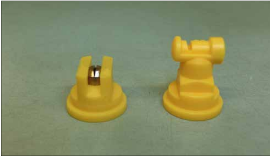
Fot. 51. Rozpylacz jednostrumieniowy rozmiar 02 (żółty): klasyczny (po lewej) i uderzeniowy (po prawej) różnią się charakterystyką wytworzonych kropli, gdy pracują pod tym samym ciśnieniem cieczy. Dla 0,3 MPa, pierwszy klasyfikowany jest jako drobnokroplisty, drugi średniokroplisty (fot. H. Ratajkiewicz)
