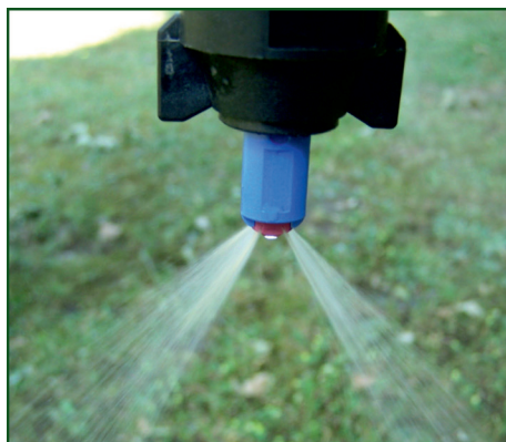
Fot. 8. Rozpylacz eżektorowy dwustrumieniowy w trakcie pracy
