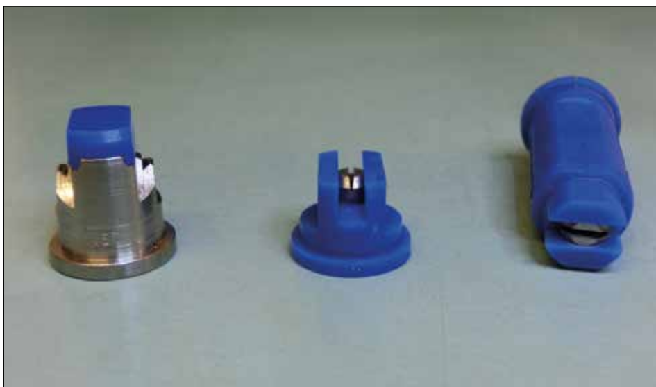
Fot. 74. Wielkość kropli wytwarzana przez rozpylacz o płaskim strumieniu zależy od jego konstrukcji. Przy tym samym wydatku i pod ciśnieniem 0,3 MPa rozpylacze przedstawione na zdjęciu klasyfikowane są następująco: bardzo drobnokroplisty – klasyczny rozpylacz dwustrumieniowy (po lewej), drobnokroplisty – standardowy rozpylacz jednostrumieniowy (w środku), bardzo grubokroplisty – rozpylacz eżektorowy (po prawej) (fot. H. Ratajkiewicz)
