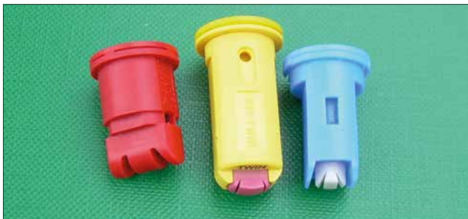
Fot. 76. Rozpylacze dwustrumieniowe eżektorowe (różnych producentów) w wersji z symetrycznymi wachlarzami (kąt pomiędzy strumieniami wynosi 60^\circ – kierunek przód/tył – jak na zdjęciu) (fot. R. Kierzek)
