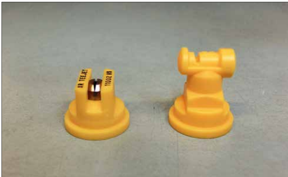
Fot. 44. Rozpylacz jednostrumieniowy rozmiar 02 (żółty): klasyczny (po lewej) i uderzeniowy (po prawej) różnią się charakterystyką wytworzonych kropli, gdy pracują pod tym samym ciśnieniem cieczy. Dla 0,3 MPa, pierwszy klasyfikowany jest jako drobnokroplisty, drugi średniokroplisty (fot. H. Ratajkiewicz)
