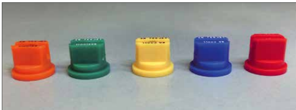
Fot. 42. Zgodnie z normami ISO kolor rozpylacza koduje jego wydajność cieczy w ciągu 1 minuty. Rozpylacze o większym wypływie cieczy wytwarzają krople o większych rozmiarach, gdy pracują pod tym samym ciśnieniem. Od lewej rozmiar: 01; 015; 02; 03 i 04 (fot. H. Ratajkiewicz)
