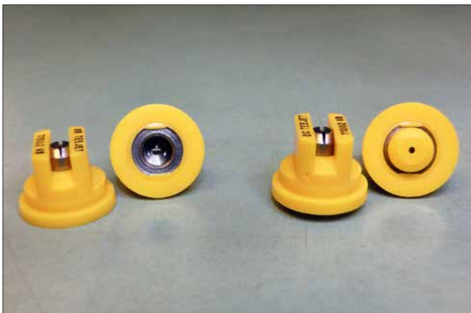
Fot. 45. Rozpylacz wyposażony w kryzę wstępną (po prawej) wytwarza krople większe i mniej podatne na znoszenie niż rozpylacz klasyczny (po lewej), mimo że ukształtowanie szczeliny wylotowej jest takie same (fot. H. Ratajkiewicz)
