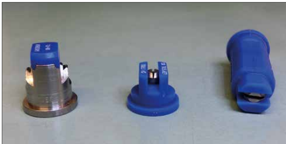
Fot. 43. Wielkość kropli wytwarzana przez rozpylacz o płaskim strumieniu zależy od jego konstrukcji. Przy tym samym wydatku i pod ciśnieniem 0,3 MPa rozpylacze przedstawione na zdjęciu klasyfikowane są następująco: bardzo drobnokroplisty – klasyczny rozpylacz dwustrumieniowy (po lewej), drobnokroplisty – klasyczny rozpylacz jednostrumieniowy (w środku), bardzo grubokroplisty – rozpylacz eżektorowy (po prawej) (fot. H. Ratajkiewicz)
