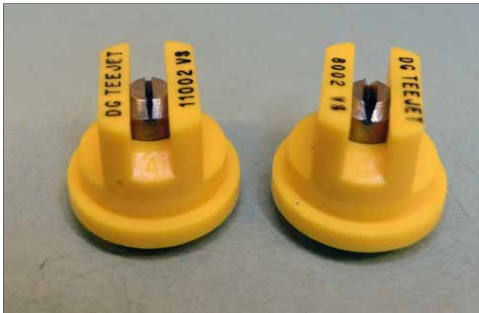
Fot. 46. Rozpylacze różniące się kątem strumienia kropli, 110° (po lewej) i 80° (po prawej) różnią się ukształtowaniem (szerokością) szczeliny wylotowej, co skutkuje wytwarzaniem nieco większych kropli przez rozpylacz o węższym strumieniu (fot. H. Ratajkiewicz)
