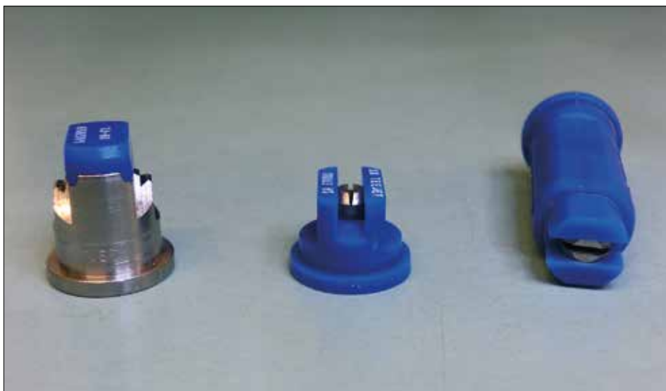
Fot. 78. Wielkość kropli wytwarzana przez rozpylacz o płaskim strumieniu zależy od jego konstrukcji. Przy tym samym wydatku i pod ciśnieniem 0,3 MPa rozpylacze przedstawione na zdjęciu klasyfikowane są następująco: bardzo drobnokroplisty – klasyczny rozpylacz dwustrumieniowy (po lewej), drobnokroplisty – klasyczny rozpylacz jednostrumieniowy (w środku), bardzo grubokroplisty – rozpylacz eżektorowy (po prawej) (fot. H. Ratajkiewicz)
