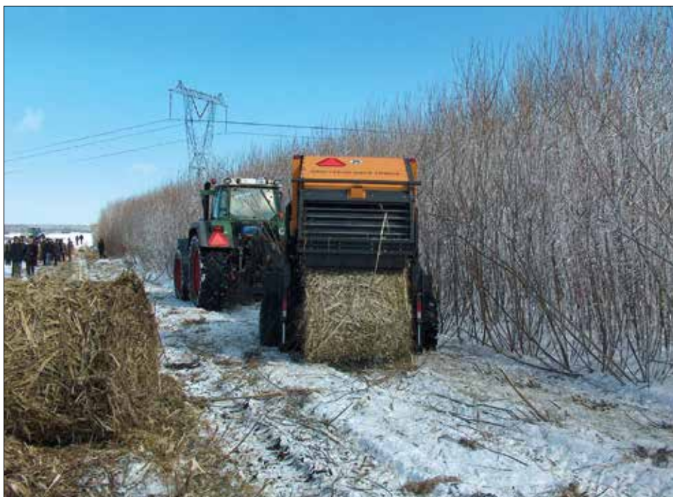
Fot. 76. Zbiór dwuetapowy wierzby za pomocą prasy ścinająco-zwijającej BIOBALER WB-55 (fot. M. Matyka)
