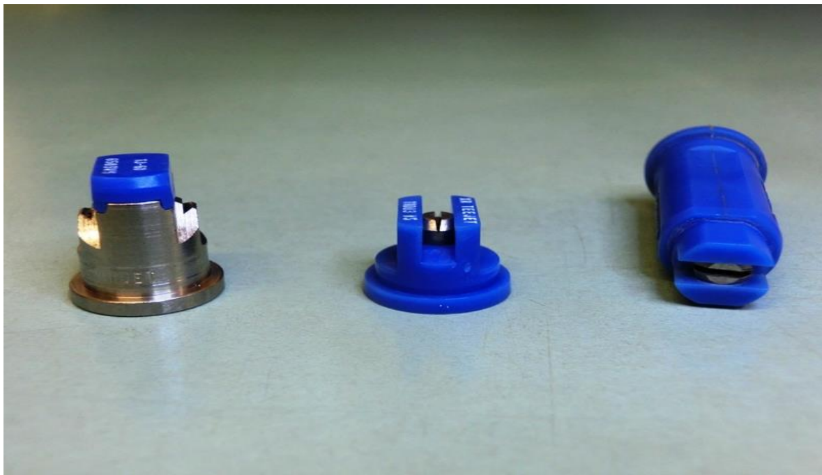
Fot. 49. Wielkość kropli wytwarzana przez rozpylacz o płaskim strumieniu zależy od jego konstrukcji. Przy tym samym wydatku i pod ciśnieniem 0,3 MPa rozpylacze przedstawione na zdjęciu (rozmiar 03- niebieski) klasyfikowane są następująco: bardzo drobnokroplisty – standardowy rozpylacz dwustrumieniowy (po lewej), drobnokroplisty – klasyczny rozpylacz jednostrumieniowy (w środku), bardzo grubokroplisty – rozpylacz eżektorowy (po prawej)
