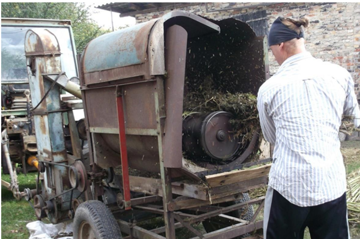
Fot. 46. Odziarnianie konopi po dojrzewaniu nasion na polu przy zbiorze dwufazowym
