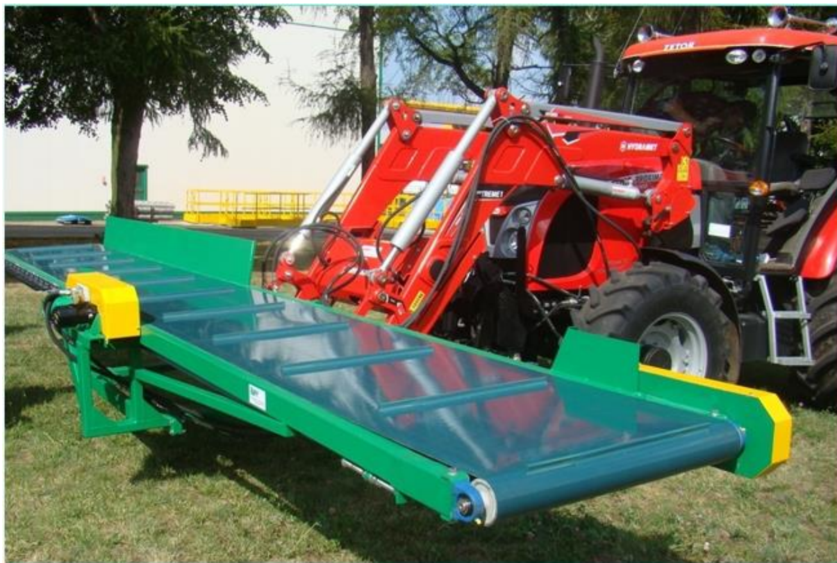
Fot. 47. Zawieszana na ładowaczu czołowym kosiarka wiech konopnych
