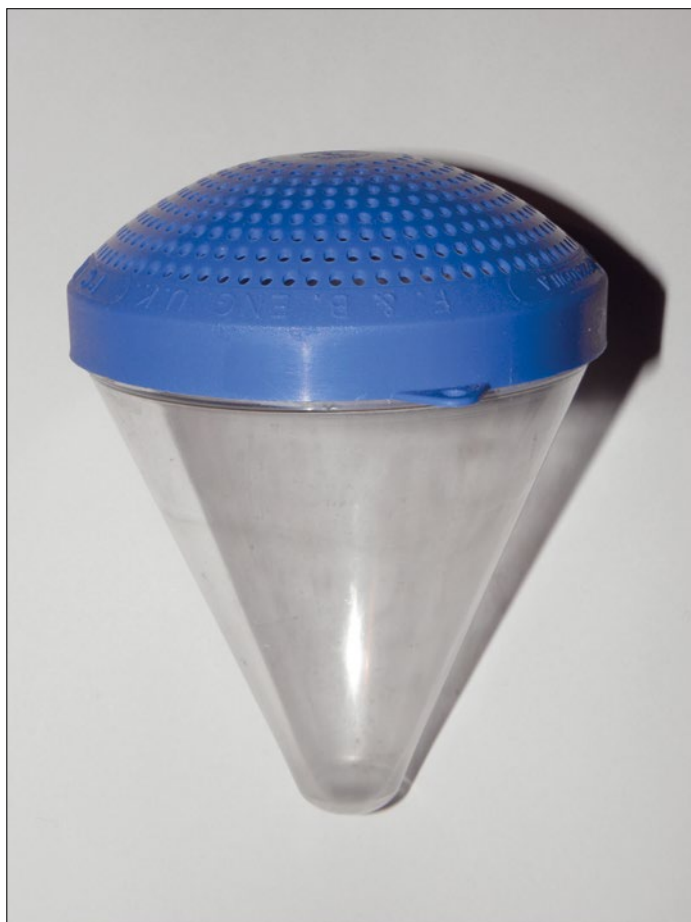
Fot. 8.2. Pułapka chwytna na chrząszcze magazynowe typu „pitfall” umieszczana w masie ziarna (fot. S. Ignatowicz)
