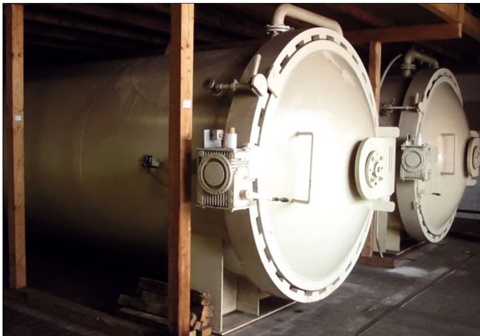
Fot. 11.2. Solidne komory wysokociśnieniowe do dezynsekcji produktów żywnościowych z zastosowaniem ditlenku węgla pod wysokim ciśnieniem (fot. S. Ignatowicz)
