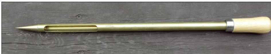
Fot. 8.1. Próbnik, nazywany zgłębnikiem magazynowym (fot. S. Ignatowicz)
