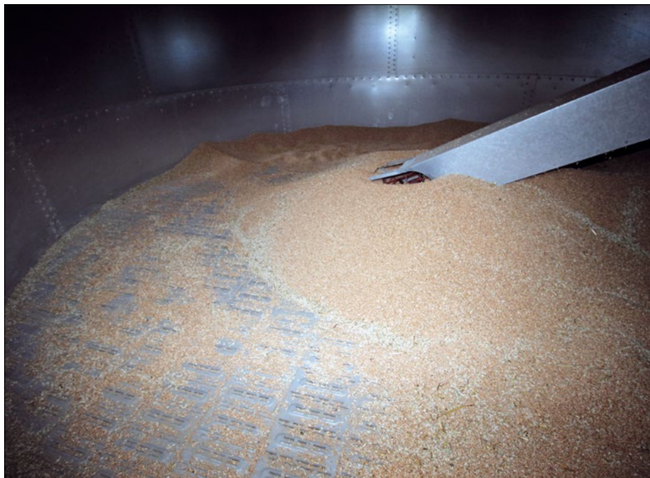
Fot. 4.8. Pozostałe wewnątrz silosu resztki ziarna, niezebrane przez przenośnik ślimakowy (fot. T. Klejdysz)
