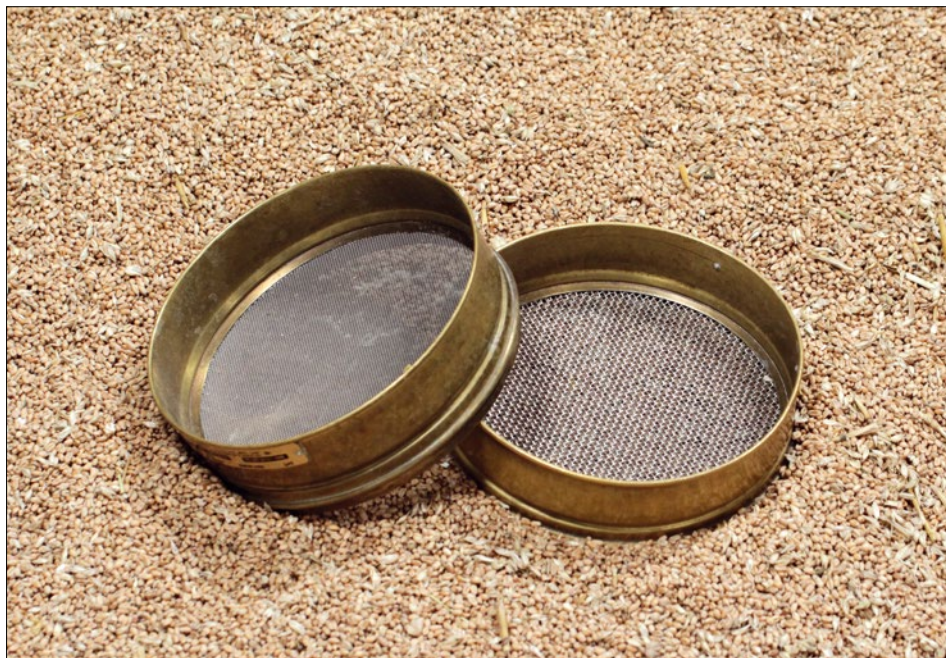
Fot. 7.2. Przykład sit do wykrywania szkodników w ziarnie (fot. T. Klejdysz)
