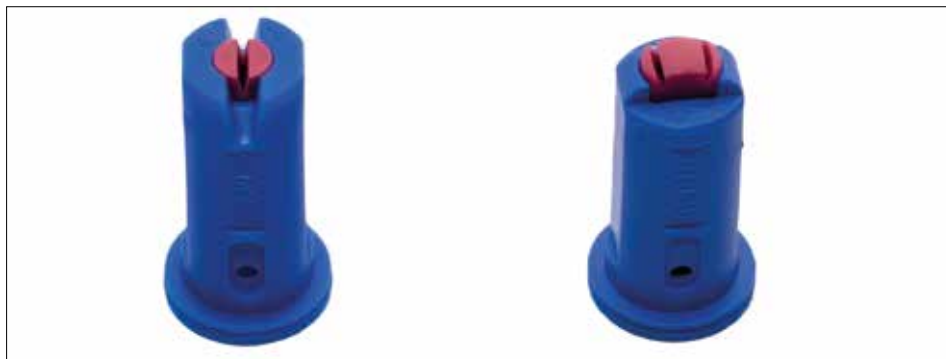
Fot. 59. Rozpylacze eżektorowe w rozmiarze 03 (niebieski): jednostrumieniowy (z lewej) i w wersji dwustrumieniowej (po prawej). Wkładki rozpylające wykonane z ceramiki (materiał bardzo trwały, odporny na rozkalibrowanie) (fot. R. Kierzek)
