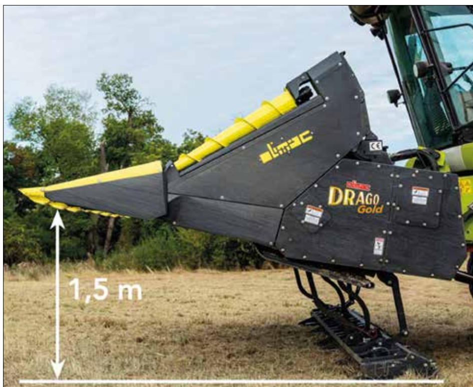
Fot. 57. W przystawce maksymalna odległość między wysokością cięcia roślin słonecznika a położeniem rozdrabniacza łodyg wynosi 150 cm
