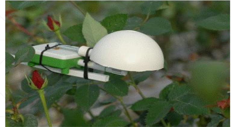
Temperature sensor (EE06-FT1A1-K300, E E Elektronik)
